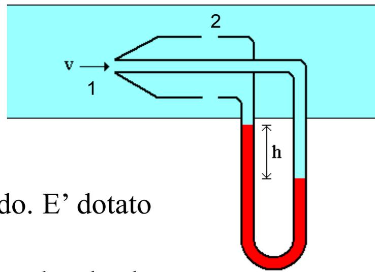
Serve per misurare la velocità di un fluido. E' dotato di un manometro differenziale.
