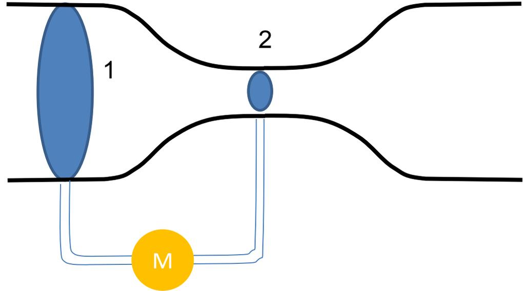
E' dotato di un manometro differenziale M per la misura della pressione
