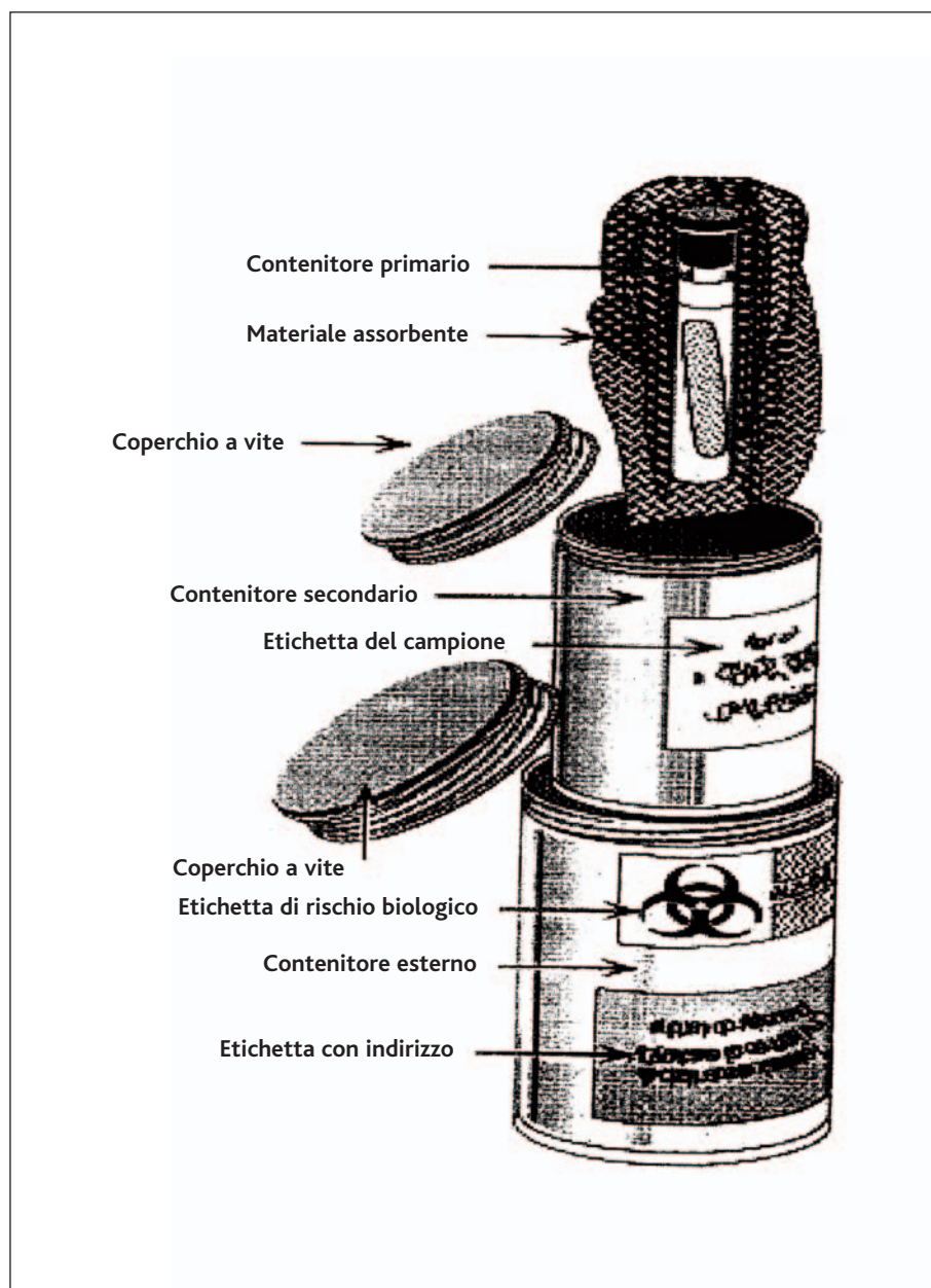
Figura 1: Sistema a triplo involucro (da: Circolare Ministero della Sanità n. 3 dell' 8/5/2003)
